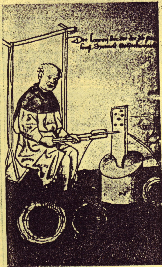
Drahtzieher. aus Nürnberger Stiftungsbuch, um 1400. Bis in das 10. Jahrhundert hinein wurden Drähte geschmiedet, das heisst, Metallplatten wurden mit dem Hammer auf Länge geschmiedet, gereckt. Mit der Erfindung der Ziehsteine, der Ziehseisen, durch die mit Zangen der Draht gezogen wurde, entwickelte sich die Drahtzieherei. Der Drahtzieher (Schockenzieher) zieht den Draht mittels einer Zange durch Löcher in der Stahlplatte, die auf einem Holzklötz befestigt ist. Die Löcher sind verschieden weit, und der Draht muß, beim weitesten beginnend, nacheinander durch immer engere Löcher gezogen werden, bis er die gewünschte Feinheit und den gewünschten Querschnitt hat. Der Drahtzieher sitzt auf einer Schocke (Wippe), um sich zum kräftigen Zug den nötigen Schwung zu geben.
